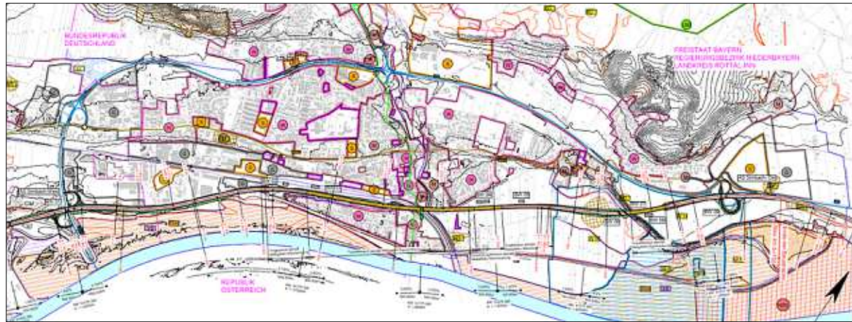
Die Variante „Au“: Hier ist im Moment kein langer Tunnel vorgesehen. Dieser endet hinter der Kreuzberger Siedlung. Die Autobahn würde im Moment in offener Bauweise durchs Wasserschutzgebiet in der Au führen.
